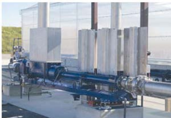
Pompă gama BTHE 70-24 cu nivelul rezervorului controlat prin intermediul celulelor de încărcare
