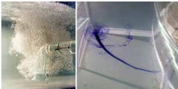
Antrenarea aerului si vartejul aratate la testarea unui model la scara..
