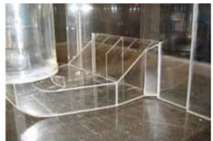
Modelul dispozitivului de admisie profilat Flygt folosit in cursul incercarii.
