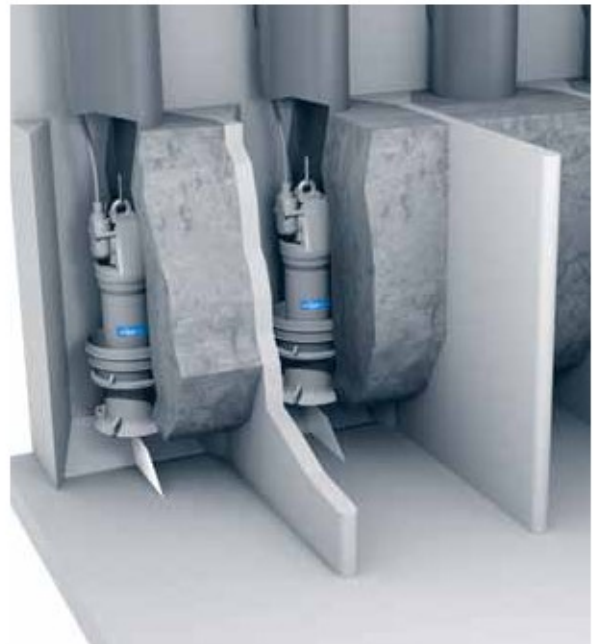
Statie de pompare cu admisie profilata realizata din beton..
