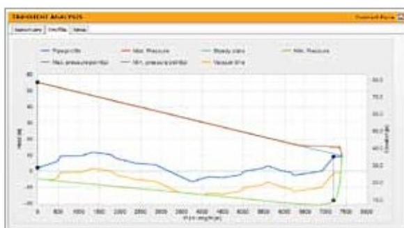
Grafice ale analizei loviturii de berbec obtinute cu" Flygt Engineering Tool."
