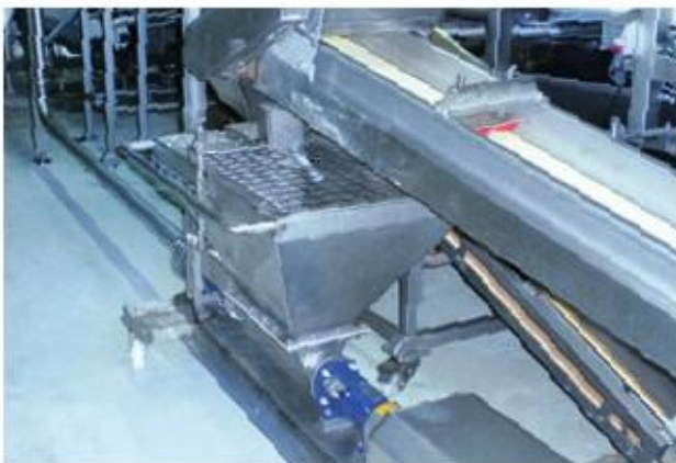
Pompa din seria TNS 2-12 Produs vehiculat: Cartofi taiati nefolosibili pentru productia de alimente congelate Debit: 1 m 3 /h (4.4 GPM) Presiune: 5 bar (72 PSI) • Temperatura: 40 °C (104 °F)
