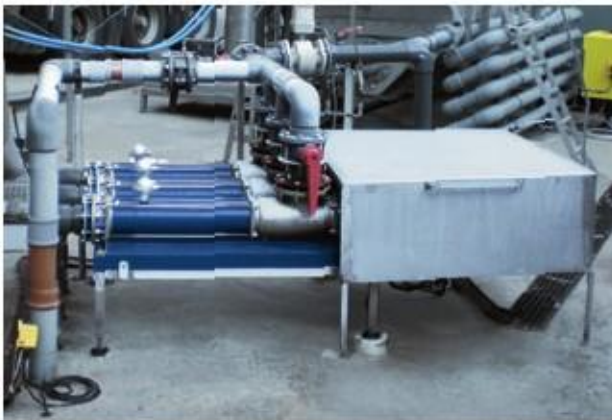
Pompe din seria BN 35-6L Produs vehiculat: reziduuri de peste cu dimensiuni de pana la 6 mm Debit: 25 m 3 /h (110 GPM) • Presiune: 1 bar (14 PSI) Temperatura: 5-20 °C (41- 68 °F)
