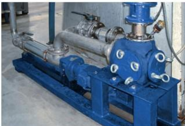
Pompa din seria BN 35-6L si macerator 110I Produs vehiculat: Deseuri alimentare diferite Debit: 25 m 3 /h (110 GPM) • Pressure: 2 bar (29 PSI) Temperatura: 40 °C (104 °F)
