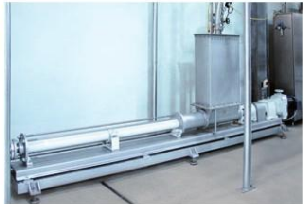
Pompe din seria TNS 10-48 Produs vehiculat: Jumari cu continut solid de pana la 26 % Debit: 3.5 m 3 /h (15 GPM) • Presiune: 30 bar (435 PSI) Temperatura: 60 °C (140 °F)
