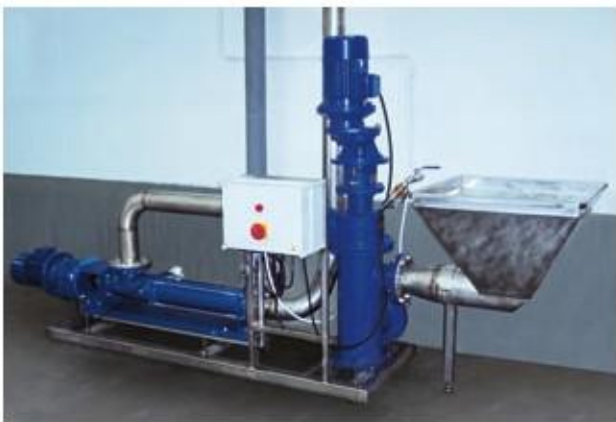
Pompa din seria BN 10-12 si macerator 25U cu separator de solide Produs vehiculat: Intestine de pui Debit: 4 m 3 /h (17 GPM) • Presiune: 6 bar (87 PSI) Temperatura: 20 °C (68 °F)
