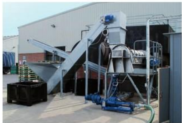
Pompa din seria BN 17-6L si macerator 25I Produs vehiculat: Diferite deseuri alimentare Debit: 8 m 3 /h (35 GPM) • Presiune: 1.5 bar (65 PSI) Temperatura: 20 °C (68 °F)
