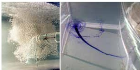
Antrenarea aerului si vortejul aratate la testarea unui model la scara.
