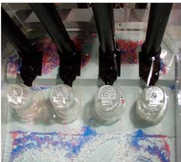
Acumularea sedimentelor pe fund aratata la testare pe model la scara.
